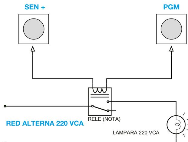
Nota: La bobina del rele debe ser de 12VCC mientras que su salida debe poder manejar 220VCA con la corriente requerida por la carga.
